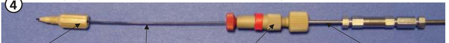
PEEK-Fingertight (6941) Glas-PEEK-Kapillare 1/32" (0,8 mm) AD Kupplung (6935-32) Säuleneingang: Edelstahlkapillare 1/16" (1,6 mm) AD
